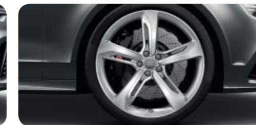
Jantes hiver en aluminium coulé style 5 branches en lames 9 J x 21 avec pneus 275/30 R 21 2 , non compatibles chaînes-neige, vitesse maximale autorisée 270 km/h
