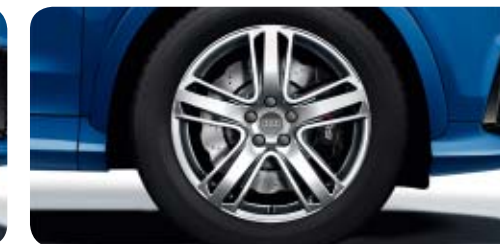
Jantes hiver en aluminium coulé style 5 branches structurées 8 J x 18 avec pneus hiver 225/50 R 18 1 , compatibles chaînes-neige, vitesse maximale autorisée 210 km/h
