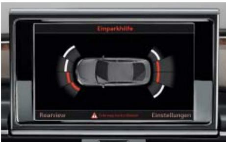
**Audi parking system plus<sup>10</sup>** signal sonore et visuel à l'avant et à l'arrière facilitant le stationnement et les manœuvres. Affichage sur l'écran MMI ; distance mesurée par capteurs ultrason discrètement intégrés dans les pare-chocs ; au choix avec en plus caméra de recul ou caméras frontale et de recul ; activation via l'engagement de la marche arrière ou via une touche sur la console centrale
