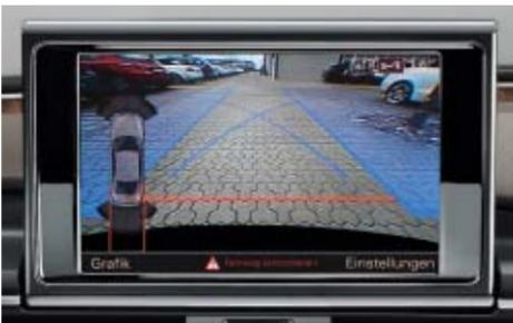
**Caméra de recul<sup>10</sup>** affichage de la zone située derrière le véhicule sur l'écran MMI, avec des modes d'affichage dynamiques pour la voie de circulation calculée selon l'angle de direction, assistance par repères graphiques et représentation des points de braquage pour les stationnements en longueur ; caméra de recul discrètement intégrée dans la poignée du coffre ; activation via l'engagement de la marche arrière ou via une touche sur la console centrale
