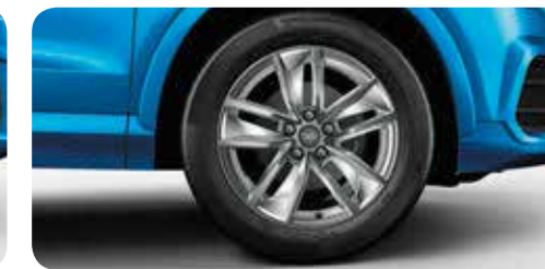
Jantes en aluminium coulé style 5 branches en turbines, partiellement polies 2 7 J x 18 avec pneus 235/50 R 18 1
