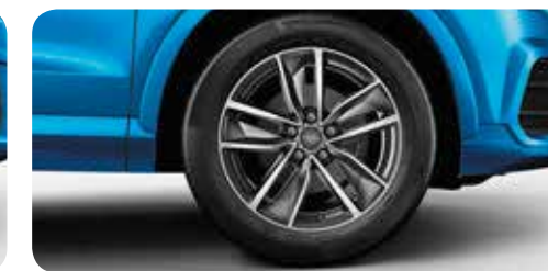
Jantes en aluminium coulé style 5 branches en turbines, gris contrasté, partiellement polies 2 7 J x 18 avec pneus 235/50 R 18 1
