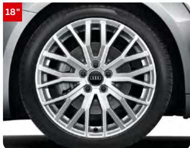
18" De série : S line Jantes en aluminium coulé style 10 branches en V partiellement polies Pneus : 245/40 R 18 93Y
