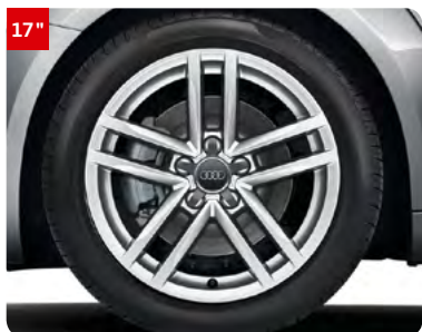
17" En option : TT Jantes en aluminium coulé style 5 branches doubles en étoile Pneus : 245/45 R17 95Y Code : C0A
