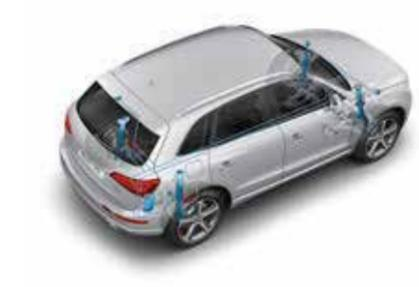
**Châssis avec amortissement piloté**
