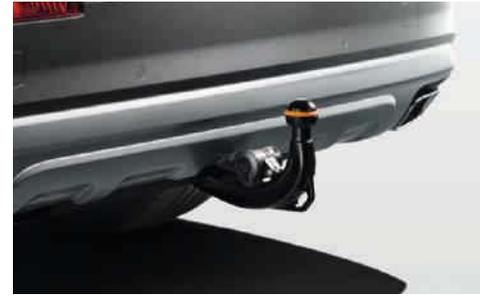
**Crochet d'attelage avec dispositif de stabilisation de l'attelage**
