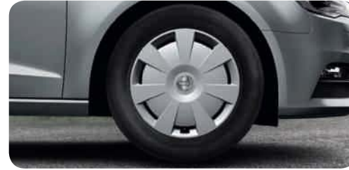
Jantes hiver en acier incluant enjoliveurs intégraux 5 6 J x 16 avec pneus 205/55 R 16 1 , vitesse maximale autorisée 210 km/h, compatibles chaînes-neige
