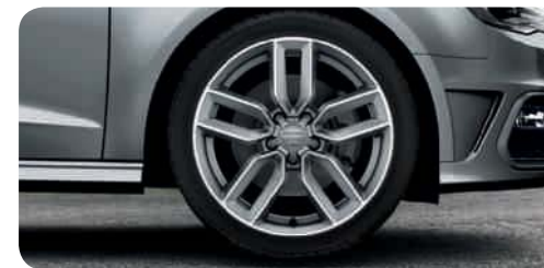
Jantes en aluminium coulé style 5 branches doubles en étoile (style S), gris contrasté, partiellement polies 3 7,5 J x 18 avec pneus 225/40 R 18 1
