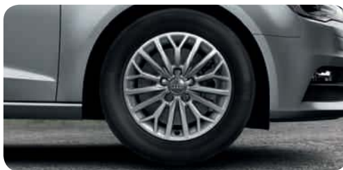
Jantes en aluminium coulé style 15 branches en Y 7 J x 16 avec pneus 205/55 R 16 3
