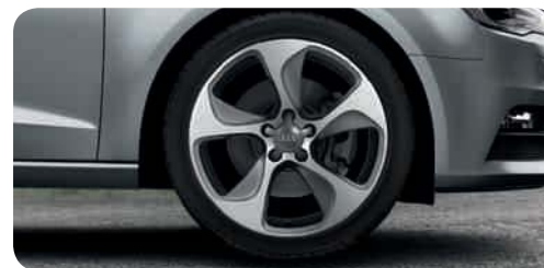
Jantes en aluminium coulé style 5 branches dynamiques, gris contrasté, partiellement polies 3 7,5 J x 18 avec pneus 225/40 R 18 1
