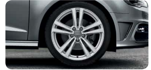
Jantes hiver en aluminium coulé style 5 branches parallèles (style 5) 7,5 J x 18 avec pneus 225/40 R 18 1 , vitesse maximale autorisée 240 km/h, non compatibles chaînes-neige
