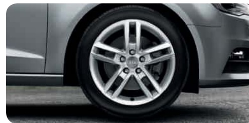
Jantes en aluminium coulé Audi Sport style 5 branches doubles 7,5 J x 17 avec pneus 225/45 R 17 1 . Une offre de quattro GmbH
