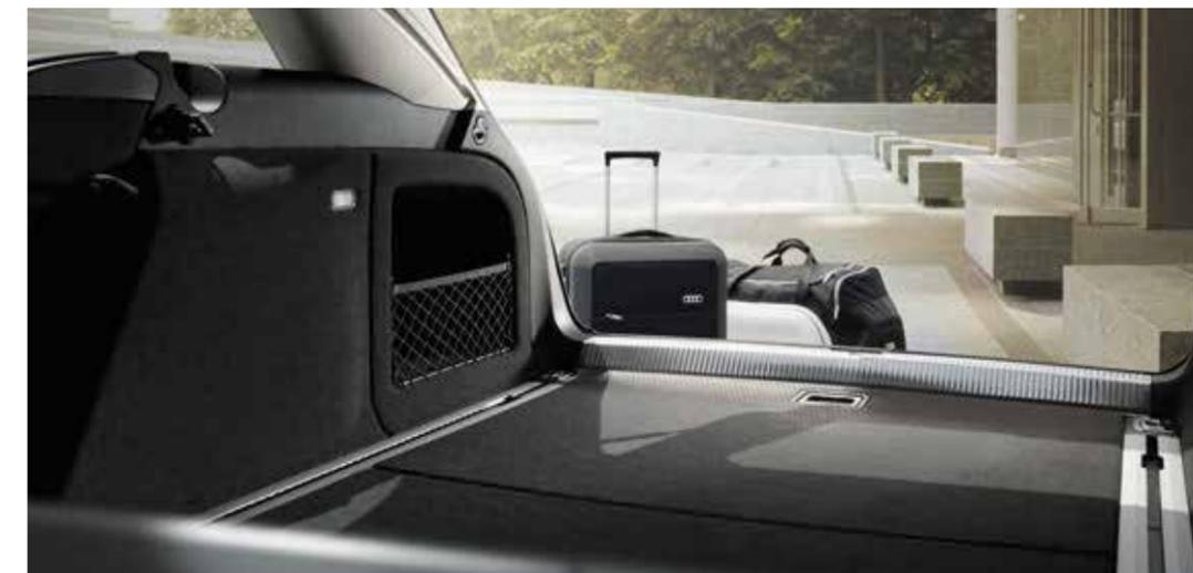
L'Audi A4 Avant est dotée d'un volume de coffre de 490 litres, qui atteint même les 1 430 litres lorsque la banquette arrière est complètement rabattue. Des œillets de fixation, des crochets pour sacs, un vide-poche avec filet et une prise de courant de 12 volts vous offrent de nombreuses possibilités pour utiliser votre coffre de manière personnalisée.
